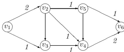
Utilizzando i nodi contrassegnati e non contrassegnati si determina il taglio minimo  $(v_1, v_2), (v_2, v_3), (v_3, v_4)$ , rappresentato in alto, che ha capacità di 3 unità.  $\diamond$
