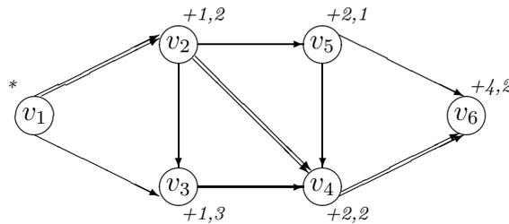
Il cammino aumentante è dato da:  $v_1 - v_2 - v_4 - v_6$  con incremento di 2 unità.
